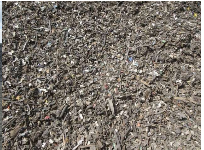
Flux de résidus de broyage de VHU après un premier criblage avant récupération de la partie ferraille
